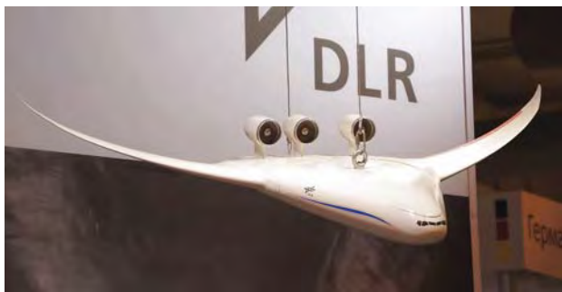
Модель самолета, выполненного по схеме BWB на стенде DLR
