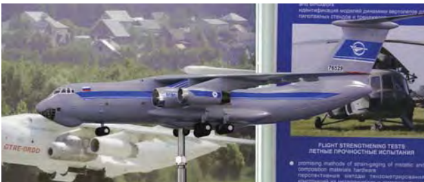
Модель ЛЛ Ил-76 для испытаний ТРДД ПД-14
